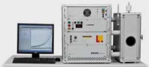
Stelar offre una vasta gamma di strumenti per FFC NMR relaxometry che, cosa unica, permettono di misurare la dipendenza del tempo di rilassamento  $T_1$  rispetto al campo magnetico, a partire dal campo terrestre fino ai campi magnetici utilizzati nell' NMR tradizionali e in ambito clinico. La dipendenza del parametro  $T_1$  rispetto il campo magnetico riporta la dinamica molecolare della sostanza.
